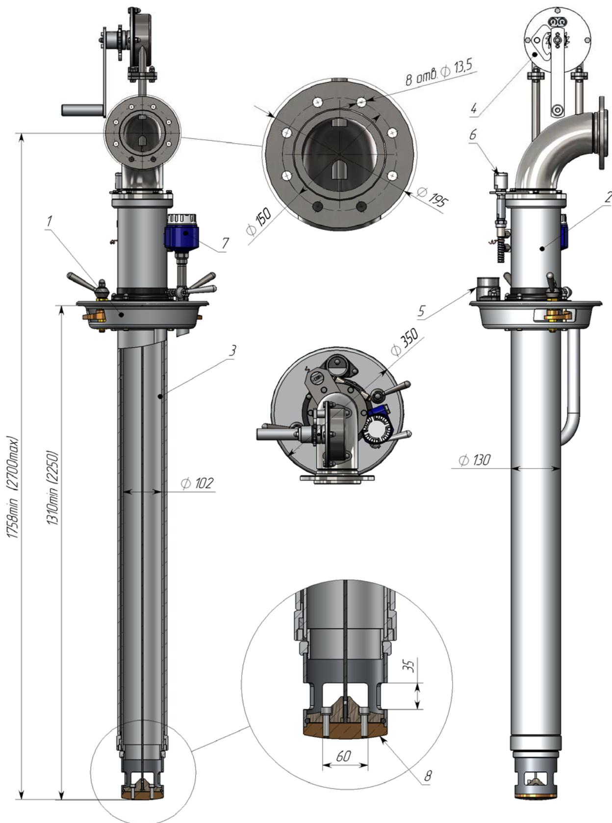
Рисунок 1 - Общий вид наконечника наливного. Габаритные и присоединительные размеры. 1 – конус, 2 – труба наружная, 3 – труба внутренняя, 4 – лебёдка, 5 – штуцер, 6 – кнопка стоп, 7 – датчик предельного уровня, 8 – пята.
